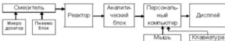
Рис.1. Функциональная схема экспресс-анализатора ОЧ
