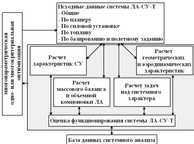
Рис. 1. Блок-схема математической модели системы «ЛА-СУ-Т»
