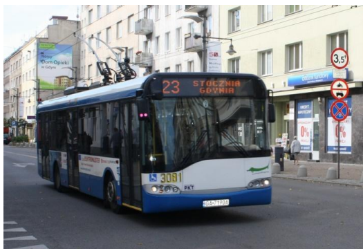
Rys. 4. Niskopodłogowy trolejbus Solaris Trollino 12T podróżujący na terenie miasta Gdyni
