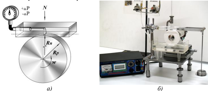
Рис. 1. Схема (а) и внешний вид (б) машины трения скольжения АСБ-01 с физически прозрачной трибосистемой
