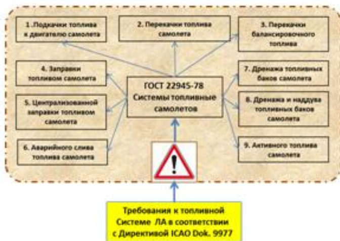
Рис. 8. Дополнительные подсистемы топливной системы самолёта в соответствии с требованиями ICAO DOC 9977
