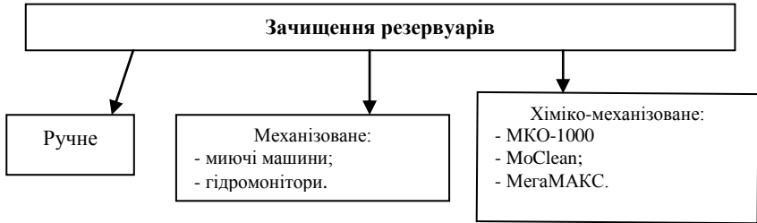
Рис. 1. Види зачищень резервуарів
