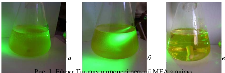
Рис. 1. Ефект Тіндаля в процесі реакції МЕА з олією
