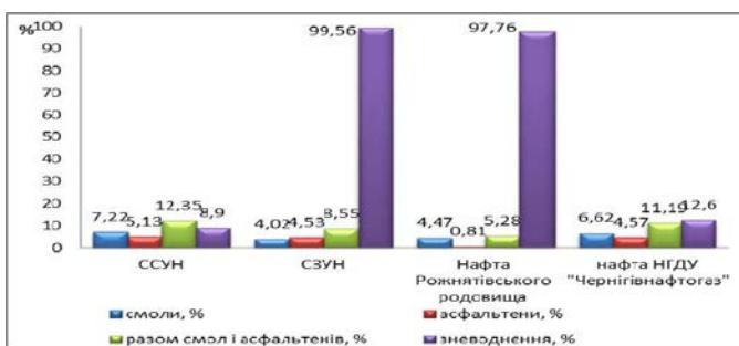
Рис. 1. Залежність ступеня зневоднення нафт за 60 °С від вмісту смол та асфальтенів і витраті деемульгатора 150 г/т
