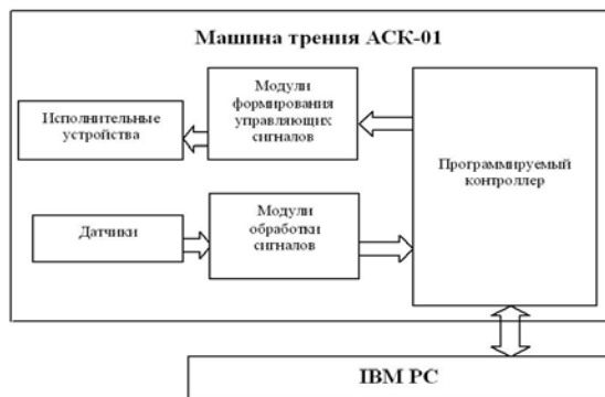
Рис. 1. Структурная схема программно-аппаратного комплекса
