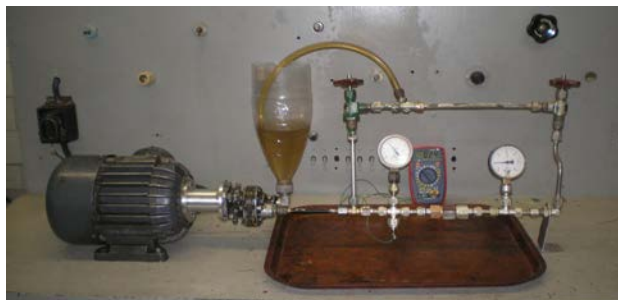
Рис. 1. Загальний вид експериментальної установки для дослідження рідин
