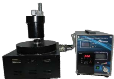
Рис. 2. Стенд СКП-01 для оценки состояния неразборных шарикоподшипников
